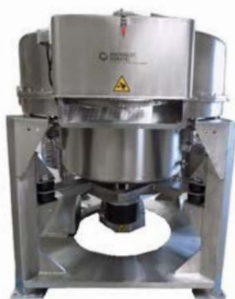
**Essoreuse automatique intégrée dans une ligne de production de salades « prêtes à l'emploi »**
