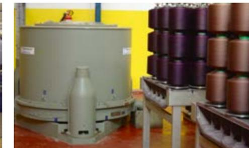
Essoreuse pour essorage de bobines de fils
