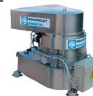
Décanteuse pour épuration
