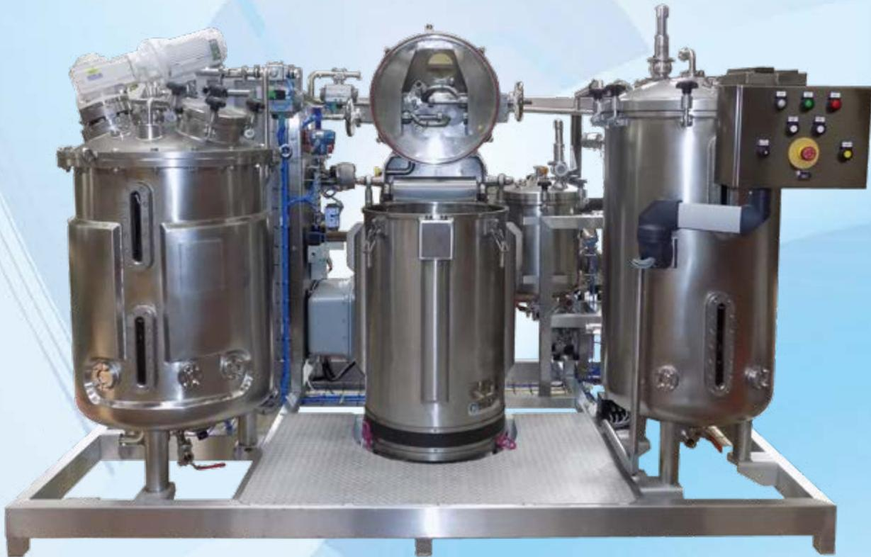
**DECANTEUSE HAUTE VITESSE sur SKID avec ses EQUIPEMENTS PERIPHERIQUES (pompes, cuve simple paroi, débitmètres, système d'inertage, cuve mélangeuse double parois thermo régulable,...) destinée au développement des BIOTECHNOLOGIES**
