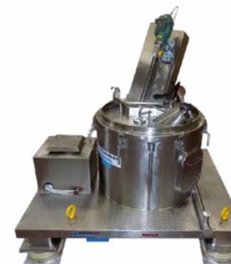
Centrifugeuse avec couvercle doté d'un agitateur escamotable monté sur rampe permettant les remises en suspension successives des gâteaux précédemment centrifugés
