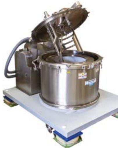
4 **Essoreuse à axe vertical pour la Chimie Fine et la Pharmacie à cycle entièrement automatique et déchargement du « gâteau » par couteau racleur.**
