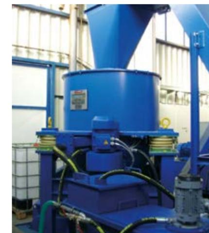
5 **Essoreuse continue pour déshuilage de copeaux aluminium**
