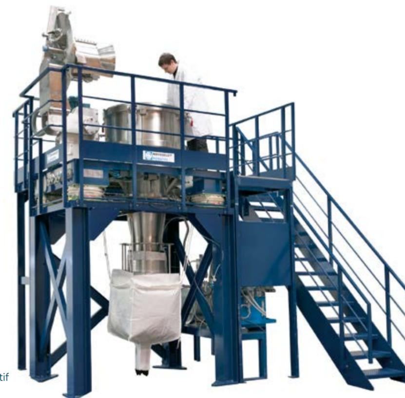
Essoreuse à cycle automatique répétitif pour chimie fine et pharmacie
